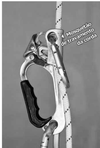
Detalhe da conexão correta do ascensor a corda. Note o mosquetão que impede o escape acidental.
