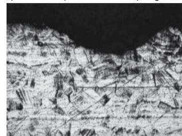
Chapeletas Petzl, detalhe da superfície corroída 400x
