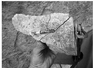
*Imagem de uma rocha fraturada devido a expansão do cone* (imagem: Mike Schneider)
